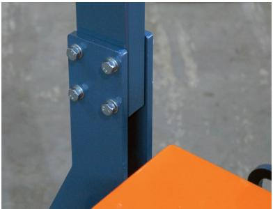
2. Поднимите рукоятку и заведите её в ответную часть, прикрепленную к корпусу машины.
