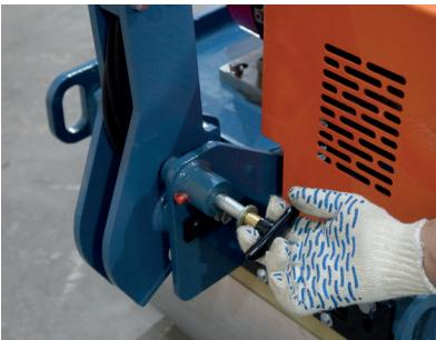
5. Вкрутите рычаг переключения хода вперёд-назад в соответствующее отверстие на рукоятке машины.
