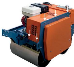
2. Ослабьте крепление натяжного ролика, и, сдвинув ролик вниз, обеспечьте необходимое натяжение ремней. После этого затяните крепление натяжного ролика.
