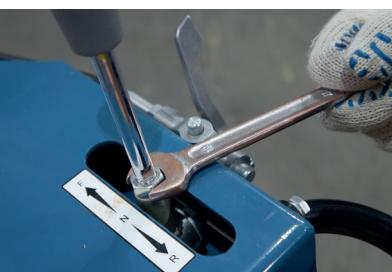
6. После вкручивания рычага, затяните контргайку гаечным ключом на 19.
