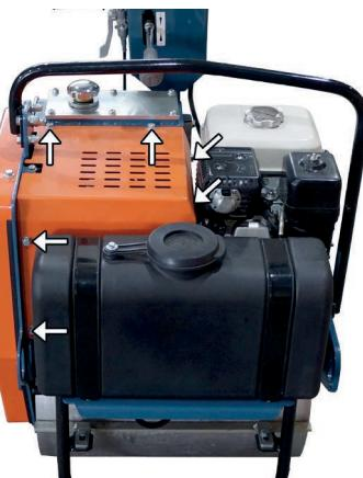
2. Отпустите болты крепления масляного насоса, и передвиньте насос по направлению к баку оросительной системы, обеспечивая необходимое натяжение ремней. После этого затяните болты.
